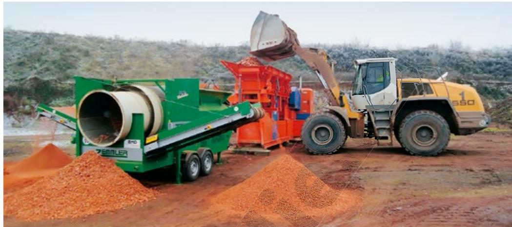
**Ergänzungsprogramm:** Als „Ersatz“ für eine containermobile Siebanlage hält BMD zur Ergänzung des Backenbrechers RA700/6 eine mobile Zemmler Siebanlage zur Verfügung. (Bild: BMD)
