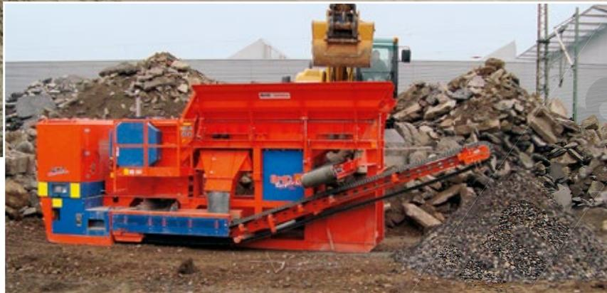
**Schnell da und wieder weg:** Der RA700/6 von BMD passt perfekt auf einen 3-Achs-Abrollkipper – entsprechend flott ist der Backenbrecher umgesetzt und einsatzbereit. Bevorzugte Arbeitsbereiche sind beengte Baustellen und kleinere Mengen. (Bild: BMD)
