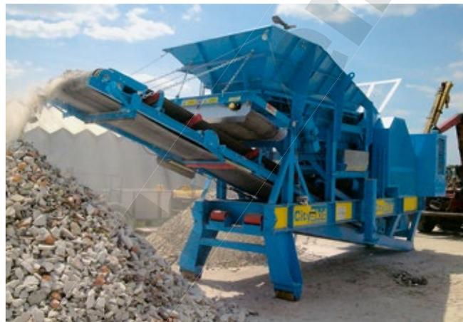
**Stadtbewohner:** Der CitySkid 9V3 ist ein containermobiler Splittbrecher für externe Stromeinspeisung – als 9V4 auch mit eigenem Dieselmotor. Mit der Wippsfuß-Vorrichtung können beide Anlagen auch ohne Kran auf Tieflader verladen werden. (Bild: Christophel)
