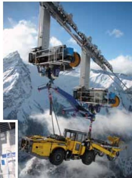
**ABHEBEN:** Der Transport aller Anlagen erfolgt über die Bauseilbahn, die 25-t-Einheiten und in Sonderfällen auch 40-t-Kaliber befördert.
